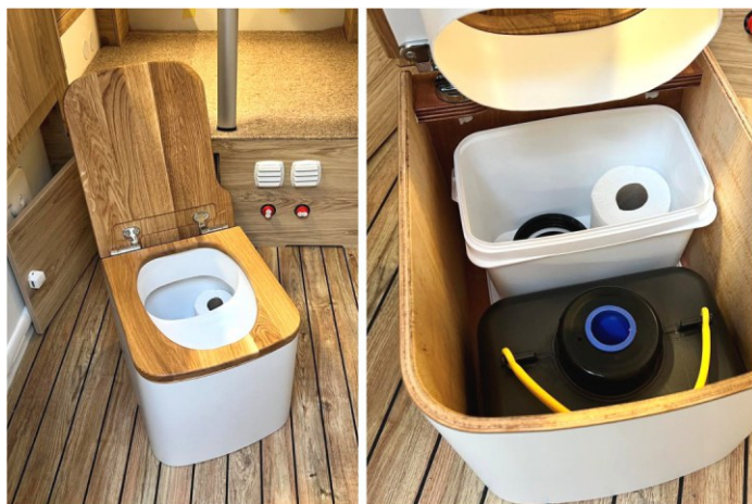
Nachhaltig getrennt: die Trocken-Trenntoilette. Wasser- und chemiefrei, etwas aufwendiger bei Handhabung und Entsorgung.
