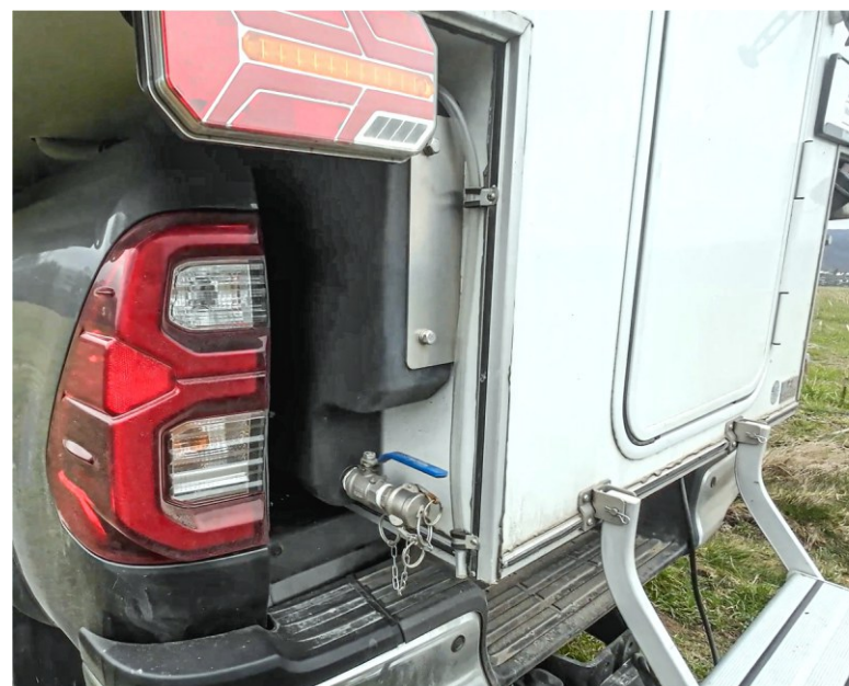
Außenliegender Grauwassertank: Für den Winterbetrieb sollten Frisch- und Grauwasser entweder innenliegend oder zumindest beheizt und damit vor Minusgraden geschützt sein. Andernfalls können schnell teure Frostschäden entstehen.
