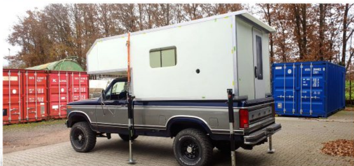
Zwei Pickups, eine Kabine. Der Eigenbau sollte sowohl auf dem RAM als auch auf dem F250 passen.
