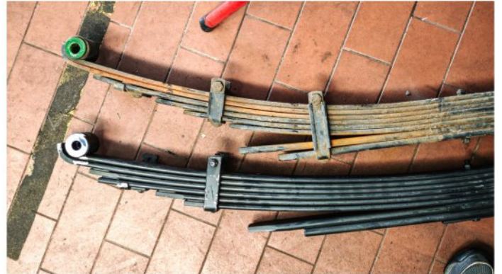
Alt gegen Neu: Blattfedern und Federbeine im direkten Vergleich
