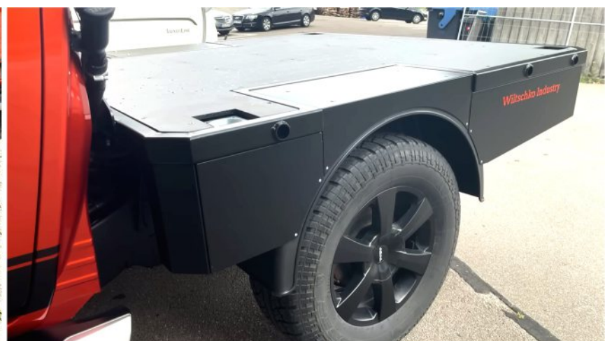
Die Flachpritsche ist mit vier Zentrierhilfen ausgestattet. Diese ermöglichen eine einfache und präzise Positionierung der Wohnkabine.
