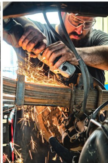
Bei den alten Blattfedern wurde nicht lange gefackelt: hier flogen die Funken. Und hat doch mal was geklemmt, kam der freundliche „Meinungsverstärker“ zum Einsatz.
