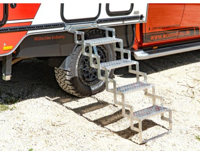
Hoch hinaus: Die stabile Scherentreppe kann für die Fahrt abgenommen und verstaut werden.
