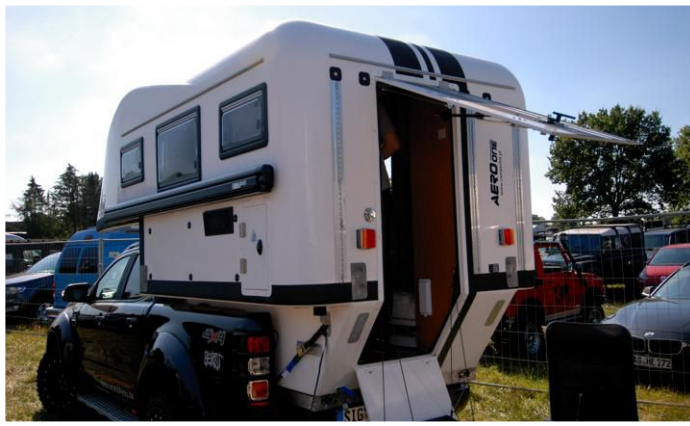
Der Einstieg in die Aero one. Der untere Teil dient als Einstiegshilfe.
