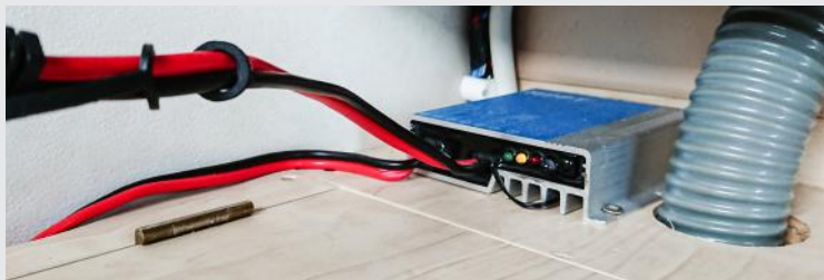
Der MTPP Solarregler sollte im Sichtbereich sein.
