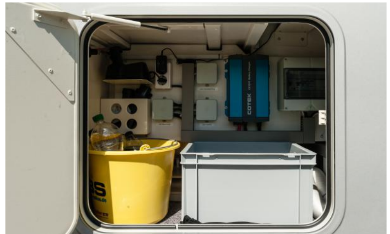
Die Gasdruckfeder verhindert das Zuschlagen der Tür bei Wind.
