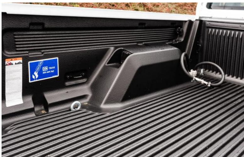
Mit Halteösen, Ladeanschluss und Anschluss für den Wärmetauscher wird der Ranger fit für die Wohnkabine gemacht.
