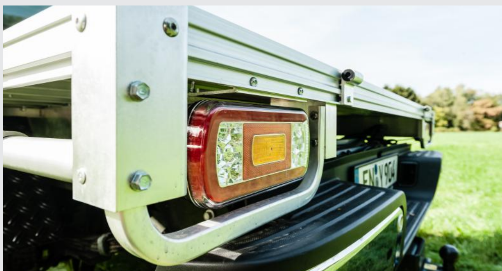
Die Rückleuchten sind gut geschützt. Rechts ist eine Brackenaufnahme und eine der acht stabilen Halteösen.
