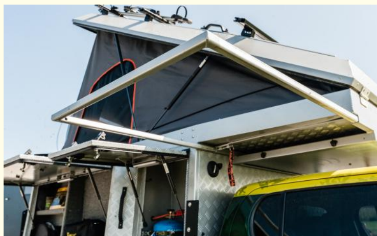
Das Geschirrfach und das Gasfach mit Außendusche. Unten ist vorne der Rahmen für den Duschvorhang.
