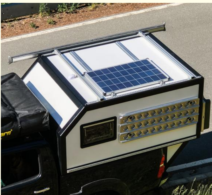
Airlineschienen und Solarpanel gehören zur Grundausrüstung.
