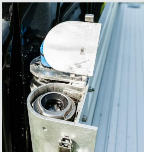
Der Dieseltankstutzen und der Füllstutzen für den Adblue Tank.
