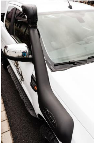
Der Safari-Schnorchel für die staubfreie Ansaugluft des Motors
