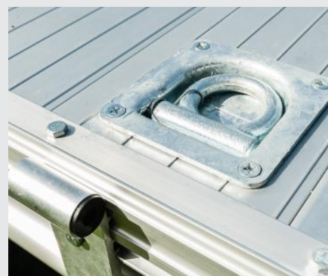
Die Rückleuchten sind gut geschützt. Rechts ist eine Brackenaufnahme und eine der acht stabilen Halteösen.
